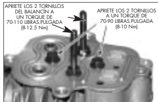
Fig. 1 - Instalación de la Platina de la Cabeza del Cilindro
