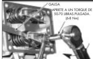
Fig. 2 - Ajuste de la Tolerancia de la Válvula
