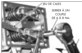
Fig. 2 – Réglage du jeu des soupapes
